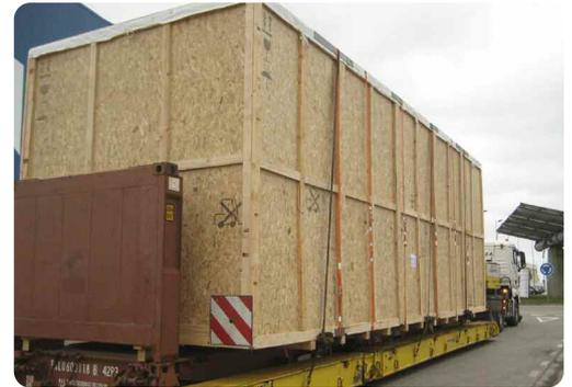
Se suelen utilizar como embalaje especialmente resistente, para aquellos casos en los que el contenido es voluminoso y pesado y el contenedor necesita ser especialmente robusto.
